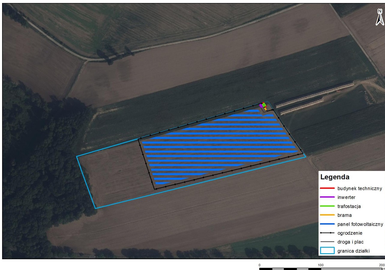
Rysunek 6 Wstępne rozmieszczenie poszczególnych elementów farmy fotowoltaicznej
