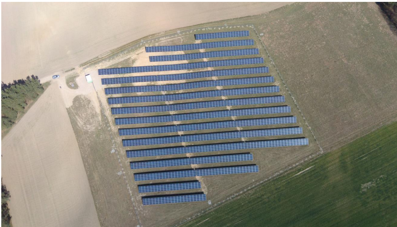
Rysunek 11 Sposób wzajemnego ułożenia paneli fotowoltaicznych
