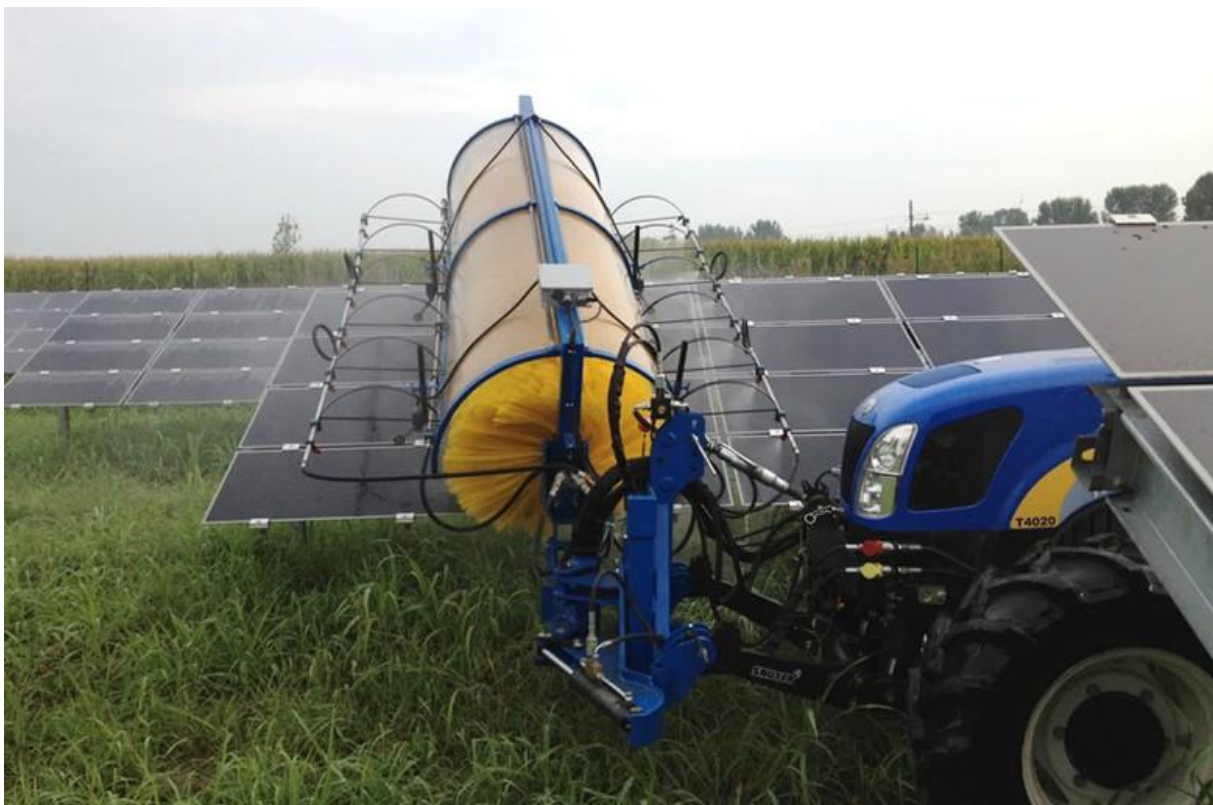
Rysunek 34 Mycie paneli fotowoltaicznych za pomocą specjalnej dostawki do ciągnika rolniczego
