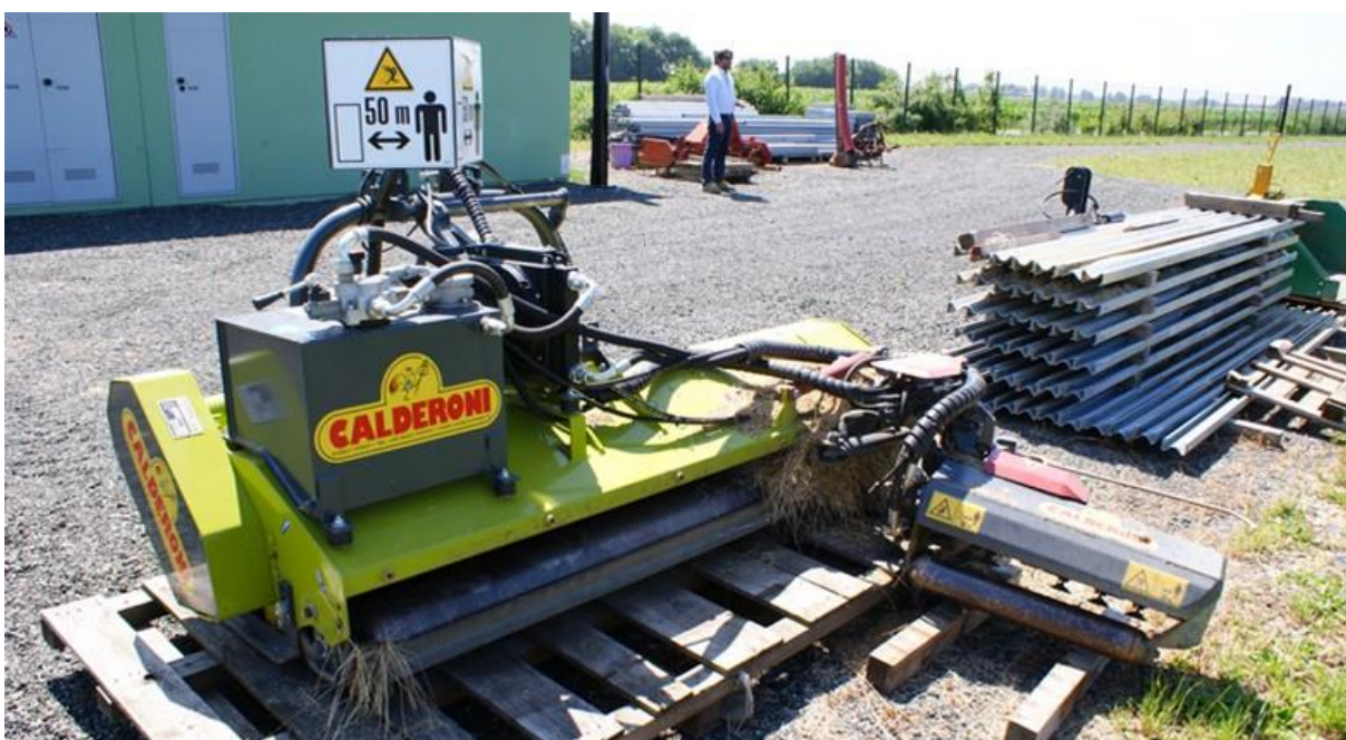
Rysunek 33 Dostawka do ciągnika rolniczego służąca do wykaszania terenu farmy
